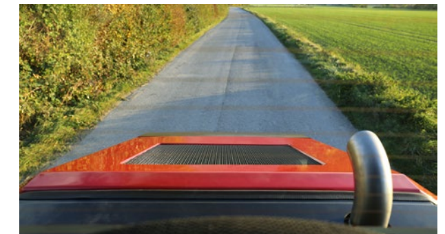
Le capot moteur incliné vers l'arrière permet de mieux voir la zone de travail derrière la machine.
