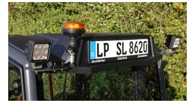
À l'arrière, il est également possible d'installer jusqu'à quatre phares de travail, ou de remplacer un phare par un gyrophare.
