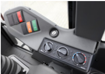
Nouvelle console: le contact, la commande de chauffage et la climatisation en option sont facilement accessibles.
