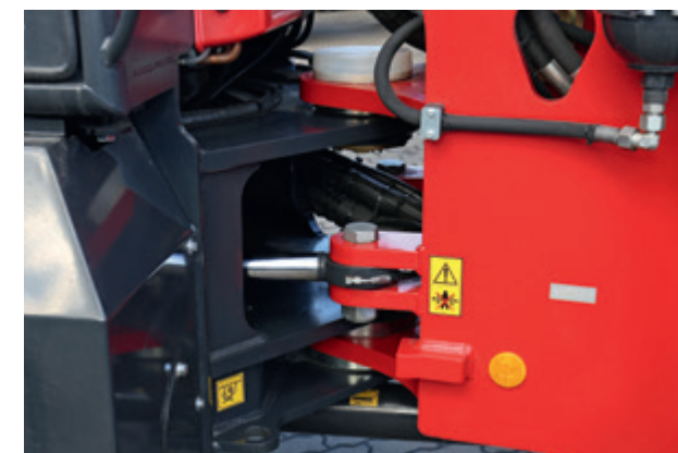
Het centraal kniksysteem is zeer sterk en onderhoudsvrij. Twee stuur cilinders zorgen voor perfecte controle.
